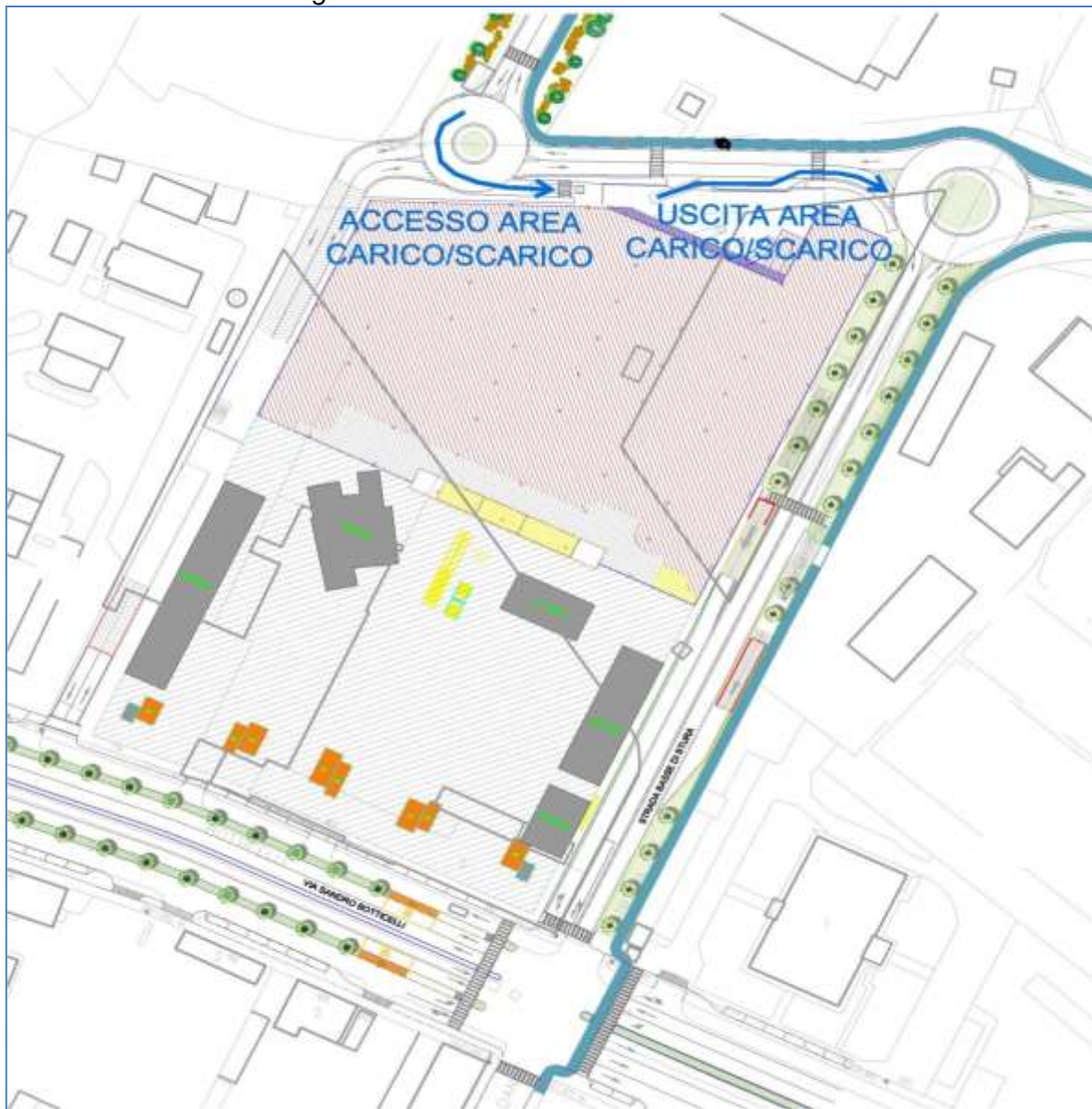
Fig. 29– Accessi alle aree di carico e scarico merci
