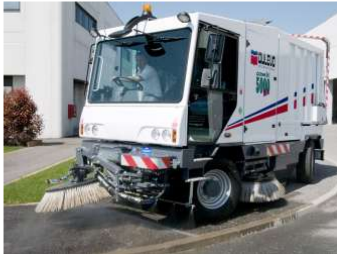
Fig. 50 – Veicoli industriali per la pulizia e lavaggio della viabilità di cantiere
